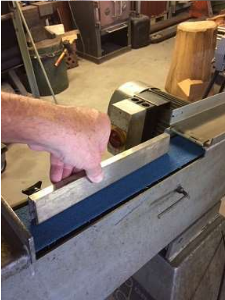
Planschleifbereich mit Kohlefaserunterlage, kann mit Klappdeckel geöffnet werden. Ermöglicht gerade Schleifarbeiten an verschiedensten Bauteilen;
